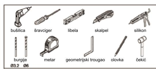
Alati i pribor: (libela; metar; ručna električna bušilica; set burgija za beton; odvrtači - ravni i zvezdasti; viljuškasti ključevi; čekić; olovka; silikon).
